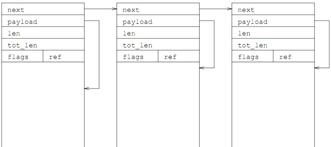
图中是分配指定大小的数据缓冲的结果，系统调用会分配多个固定大小的 PBUF\_POOL 类型 pbuf，并把这些 pbufs 链成一个链表，以满足用户的分配空间请求。
