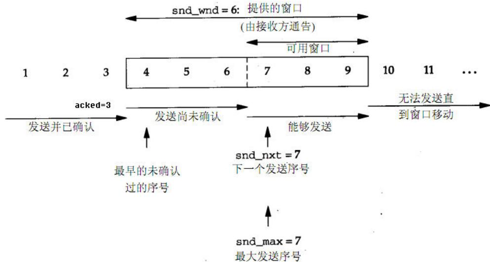
除了发送窗口外，TCP 连接的双方还各自维护了一个接收窗口，如下图，接收方的接收窗口和发送方的发送窗口对比起来看看数据包的交互过程。
