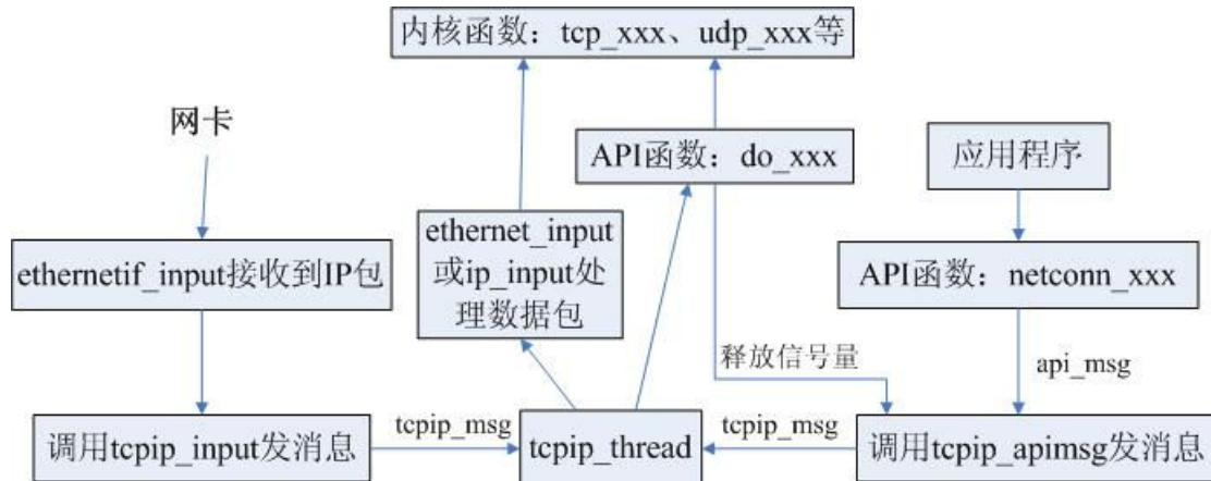
从上面的图中可以清晰的看出两部分 API 函数之间的交互过程，以及应用程序和内核函数之间的交互过程。API 函数 `netconn_xxx` 在文件 `api_lib.c` 中，而 API 实现的另一部分函数 `do_xxx` 在 `api_msg.c` 中。
