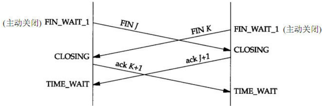
关闭操作时，两主机都向对方发送一个 FIN 包，并进入 FIN\_WAIT\_1 状态等待对方的 ACK 返回，但一段时间后，双方各自都收到对方的 FIN 包，而不是 ACK 包，此时两主机都判定遇到了双方同时主动关闭的状况，此时，两个主机就没有必要进入 FIN\_WAIT\_2 状态等待对方的 FIN 包了，因为这个包刚刚已经收到，而是直接进入 CLOSING 状态，并向对方发送一个 FIN 包的确认，等到双方都收到对方的 ACK 包后，两边都各自进入 TIME\_WAIT 状态。
