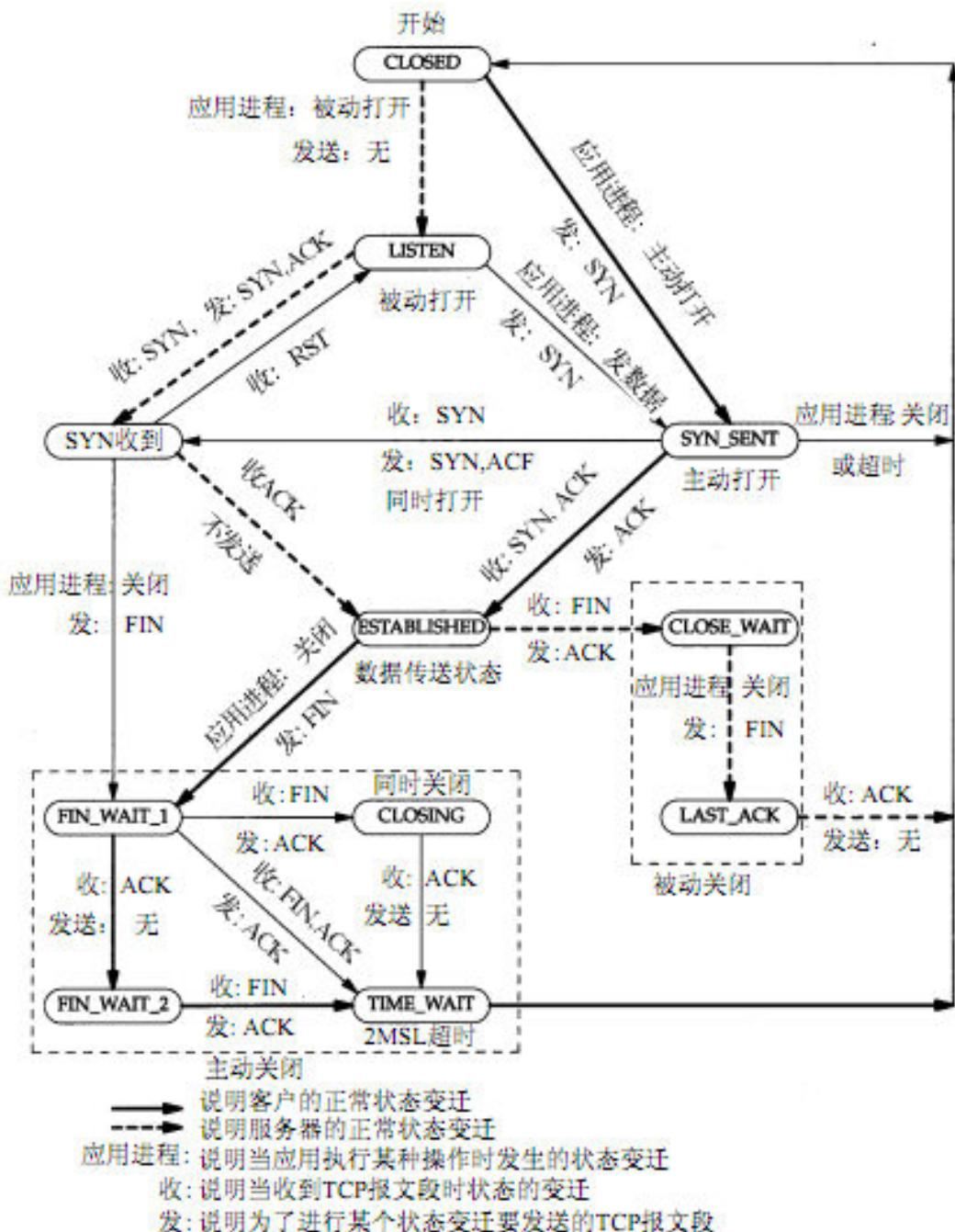
图中有两个典型的状态转换路径，第一个是客户端申请建立连接与断开连接的过程，如图中黑色粗线所示：与前面描述的一致，在客户端通过发送一个 SYN 包，主动向服务器申请一个连接，数据包发出后客户端进入 SYN\_SENT 状态等待服务器的 ACK 和 SYN 包返回，当收到这个返回包后，客户端对服务器的 SYN 进行确认，然后自身进入 ESTABLISHED 状态，与前面描述的三次握手过程完全一致。当客户端申请断开连接时，它要发送 FIN 包
