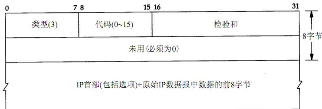
先讲与 icmp\_dest\_unreach 函数所描述的目的不可达差错报文。该报文的类型字段值应为 3，代码字段值应为 (0~15)，目前 LWIP 只支持 (0~5)，分别表示网络不可达、主机不可达、协议不可达、端口不可达、需进行分片但设置了不分片位、源站选择失败。很明显，在 ip\_input 函数找不到将该数据包交到哪个上层协议时，应该产生一个协议不可达的差错报
