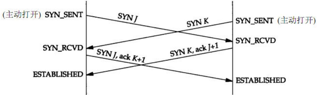
发送自身的 SYN 请求包后各自进入 SYN\_SENT 状态，等待对方的 ACK 包返回，但一定时间后，每个主机都收到对方的 SYN 包而不是 ACK 包，此时两端都判定已经遇到了同时打开的状况发生，两端都进入 SYN\_RCVD 状态，并对对方的 SYN 进行确认并再次发送自己的 SYN 包，当接收到对方的 ACK+SYN 后，两边都进入 ESTABLISHED 状态。从这一点看，状态转换图中的从 SYN\_RCVD 到 ESTABLISHED 转换的条件应该有两个，而图中只标出了一个。一个同时打开的连接需要交换 4 个报文段，比正常的三次握手多一个。要注意的是在这样的连接过程中，没有将任何一端称为客户或服务器，因为每一端既是客户又是服务器。
