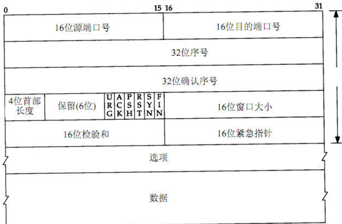
源端口号和目的端口号，用于标识发送端和接收端的应用进程。这两个值加上 IP 首部中的源 IP 地址和目的 IP 地址就能唯一确定一个 TCP 连接。一个 IP 地址和一个端口号也称为一个插口 (socket)。
