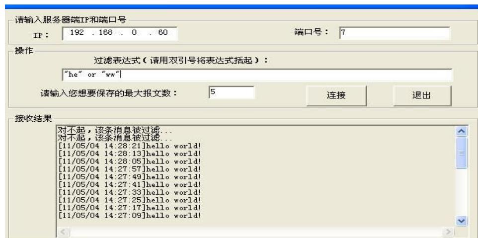
过滤表达式编辑框内的内容是用户输入的过滤条件，当接收的数据串满足过滤条件时，该字符串不会在接收结果中显示出来。过滤条件是一系列的引号括起来的字符串，它们可以用 or, and, not,括号等连接起来，组成很复杂的过滤条件。。不讲了。
