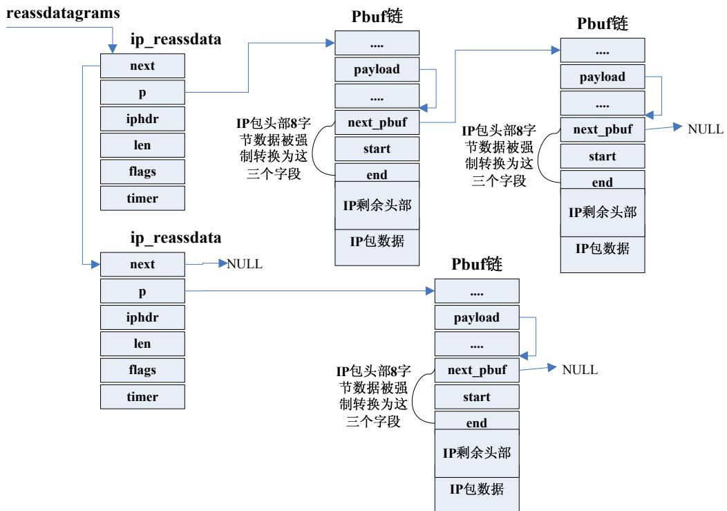
图中展示了有两个数据包正在被组装的过程，两个 `ip_reassdata` 结构分别用于两个数据包的组装过程。第一个数据包已经组装好了两个分片数据，第二个组装好了一个分片数据。LWIP 并不像标准协议中描述的那样，另外分配一个数据结构来描述各个分片数据，而是直接利用各个分片数据，将数据中 IP 头部的前八个字节拿来存储组装过程中的相关信息，因此每个进来的 IP 分片数据包头都被改变了，也因此要使用 `ip_reassdata` 结构中的 `iphdr` 字段来暂时保存 IP 数据包的完整头部。
