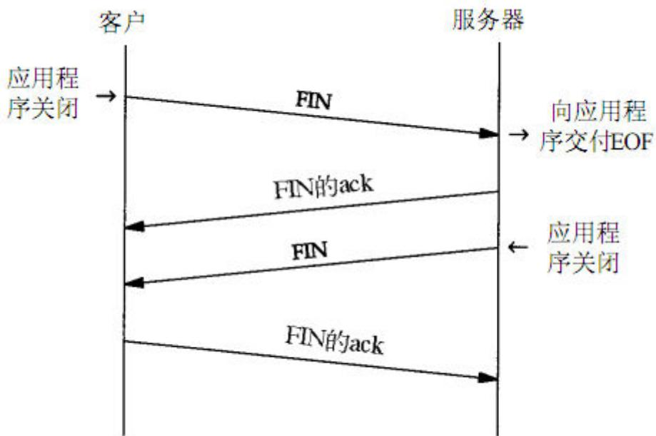
在这个图中，发送 FIN 将导致应用程序关闭它们的连接，这些 FIN 的 ACK 是由 TCP 软件自动产生的。连接断开的主动发起方通常是客户端，但如果是服务器首先发起 FIN 包，上图的握手过程也是完全成立的。
