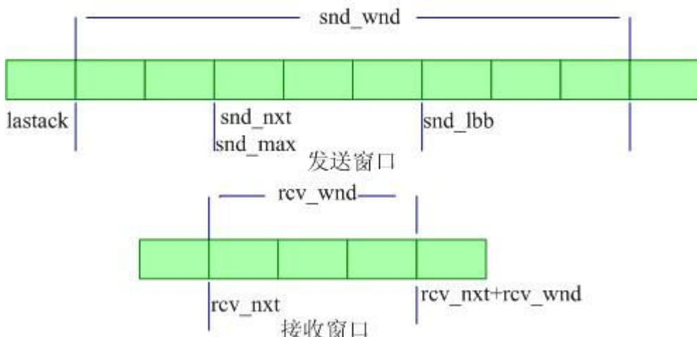
接收窗口有三个字段 `rcv_nxt`、`rcv_wnd`、`rcv_ann_wnd`，其中 `rcv_nxt` 表示下一个将要接收的数据序号，`rcv_wnd` 表示接收窗口的大小，`rcv_ann_wnd` 表示向发送方通告的窗口大小。接收窗口相对于发送窗口来说更简单，我们也在上图中加以描述。那么 TCP 连接两端的滑动窗口是如何实现的呢？现在以客户机与服务器之间连接建立过程来看看滑动窗是如何工作的。
