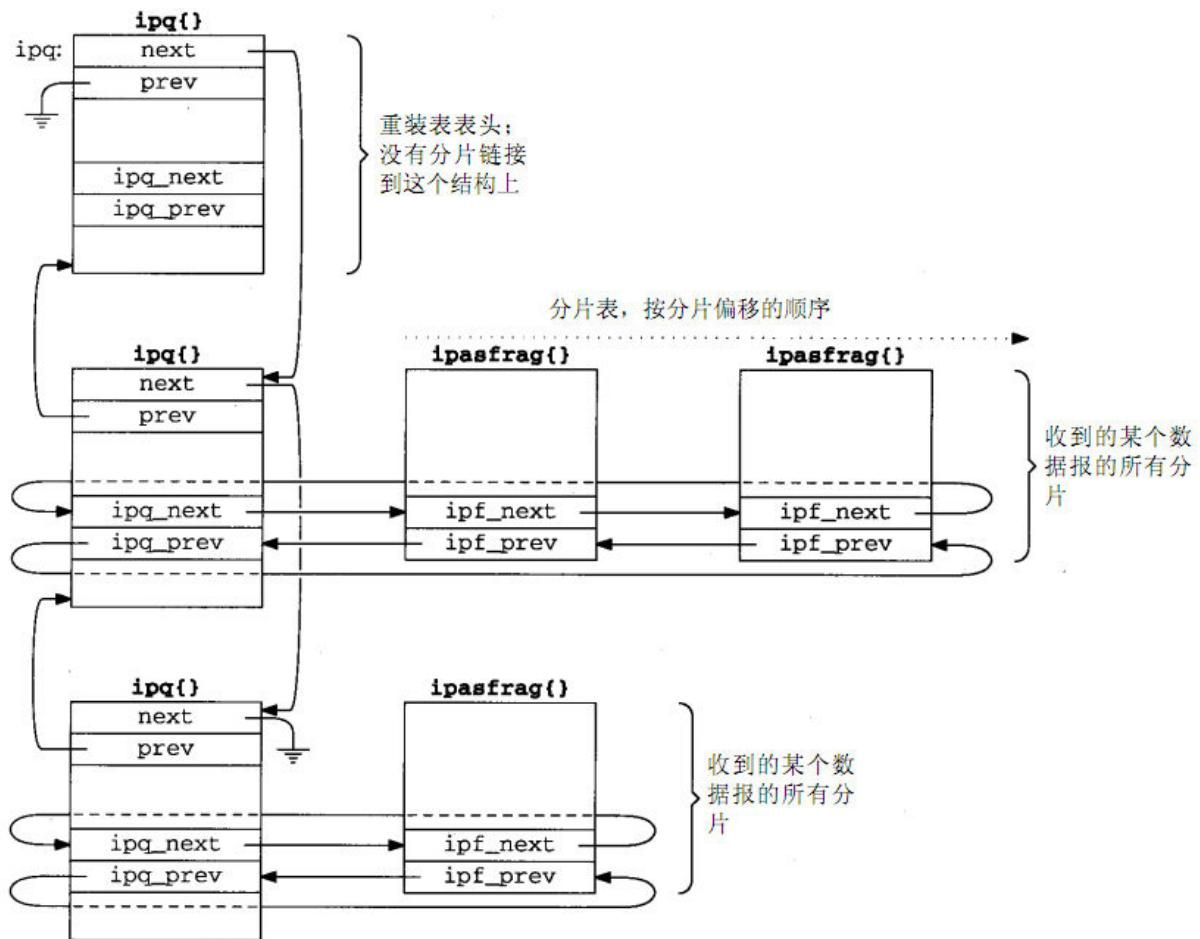
标准中主要采用了两个数据结构来实现数据包的重装，`ipq` 和 `ipasfrag`。其中 `ipq` 是为某个将要重组的数据包建立的节点信息数据结构，包括目标 IP 地址，数据包编号等信息，该结构还有指针 `ipf_next`、`ipf_prev` 使得该数据包的各个分片数据组成一个双向链表，图中 `ipasfrag` 用于包装各个分片信息包。同时，将所有 `ipq` 结构体构成一个双向链表，便于某个 `ipq` 结构的查找、插入和删除操作。整个 `ipq` 构成的链表有一个固定的链表头，该表头不存
