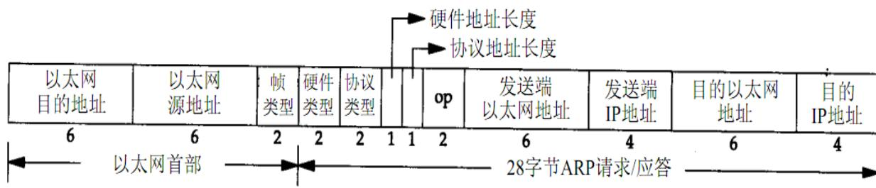
以太网包头中的前两个字段是以太网的目的 MAC 地址和源 MAC 地址，在前面一章已经有讲解。目的地址为全 1 的特殊地址是广播地址。在 ARP 表项建立前，源主机只知道目的主机的 IP 地址，并不知道其 MAC 地址，所以在数据链路上，源主机只有通过广播的方式将 ARP 请求数据包发送出去。电缆上的所有以太网接口都要接收广播的数据包，并检测数据包是否是发给自己的，这点通过对照目的 IP 地址来实现，如果是发给自己的，目的主机需要回复一个 ARP 应答数据包给源主机，以告诉源主机自己的 MAC 地址。
