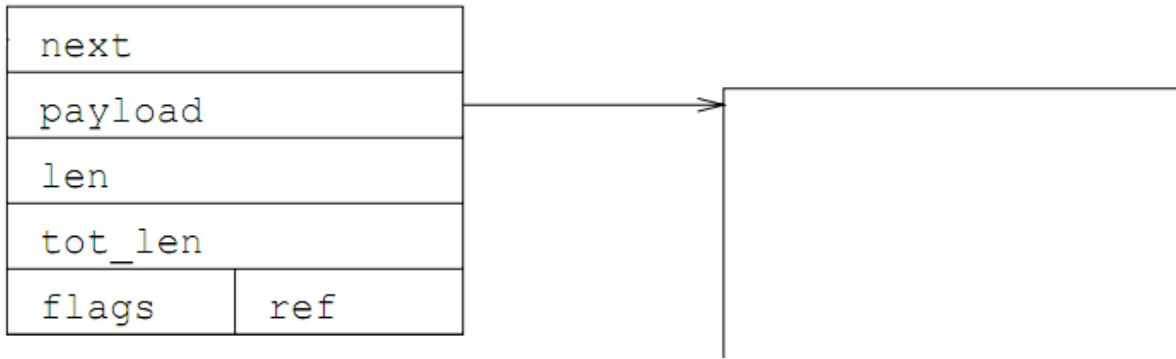
注：以上所有图片都来自文档《Design and Implementation of the LWIP: TCP/IP Stack》，这些图都有个共同的错误，即 **len** 和 **tot\_len** 字段位置搞反了，窃喜。
