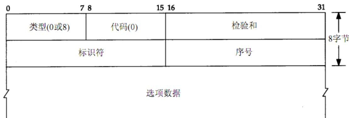
`icmp_input` 函数处理接收到的 ICMP 数据包，并根据包类型做相应的处理。目前 LWIP 只能处理 ICMP 回显请求包，对其他类型的 ICMP 包不做响应，这在嵌入式产品中是足够用了的。对于 ICMP 回显请求，`icmp_input` 需要生成一个回显应答报文返回给源主机。
