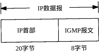
图13-1 IGMP报文封装在IP数据报中
