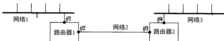
图8-3 traceroute 程序打印出的接口标识
