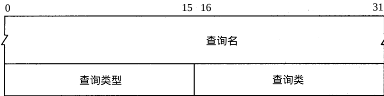
图14-5 DNS查询报文中问题部分的格式
