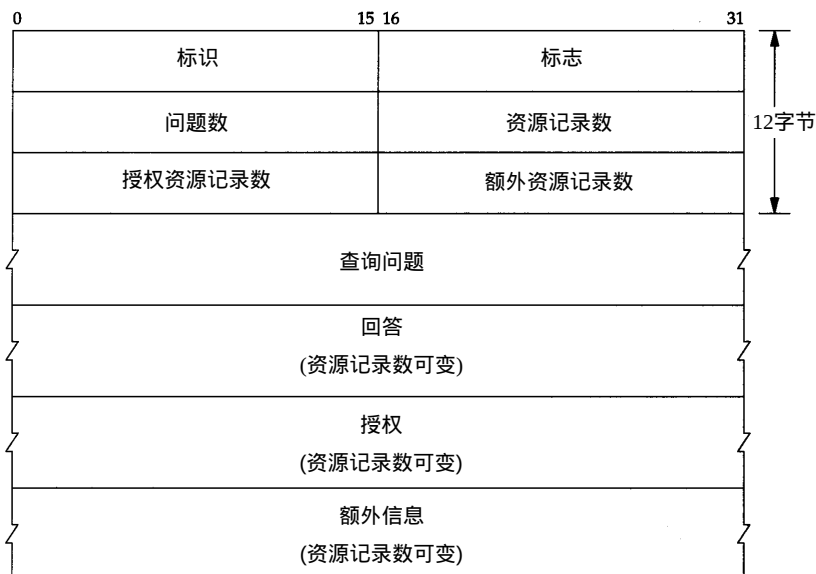
图14-3 DNS查询和响应的一般格式
