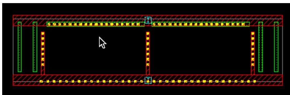
上方的绿色矩形是 poly，和中间红色的 M1 组成所谓的 Diffusion Capacitor (N Well Capacitor 的一种实现)。这个 capacitor 的两端分别和 Power 和 Ground 相连。
