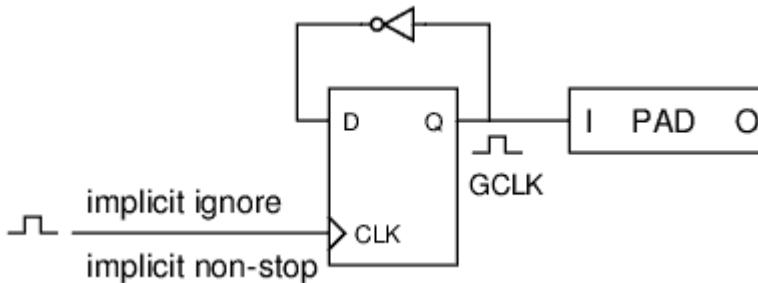
其中的 register 被用做二分频，输出端 Q 通过一个 inverter 连接到了自己的输入端上；Q 端上定义了一个 Generated Clock(GCLK)。
