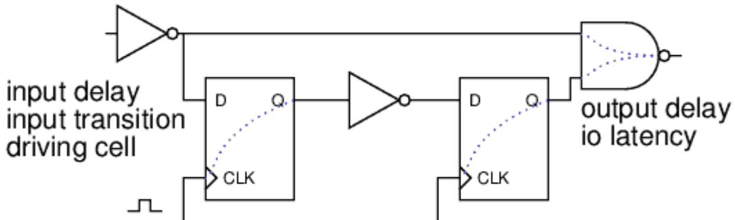
上面提到的  $t_{\text{data}}$  其实就是数据沿着一条数据通道传递所用的时间。而这条数据通道，我们就叫做 **Timing Path**。总结一个 **Design** 中可能的 **Timing Path**，有下面四种：
