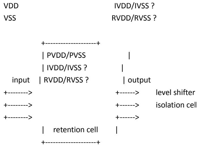
如果当前区域的电源电压和外部不同，则信号传输时需要电平转换。这可以通过在信号线中间插入被称为 **Level Shifter** 的 cell 来实现。
