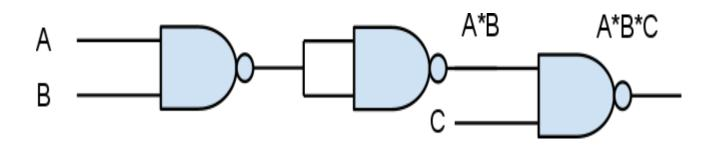
Figure 13. 3 Input NAND using 2 input NAND.
