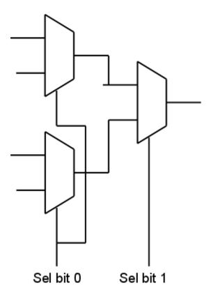
Figure 15. 4:1 MUX Using 2:1 MUXes
