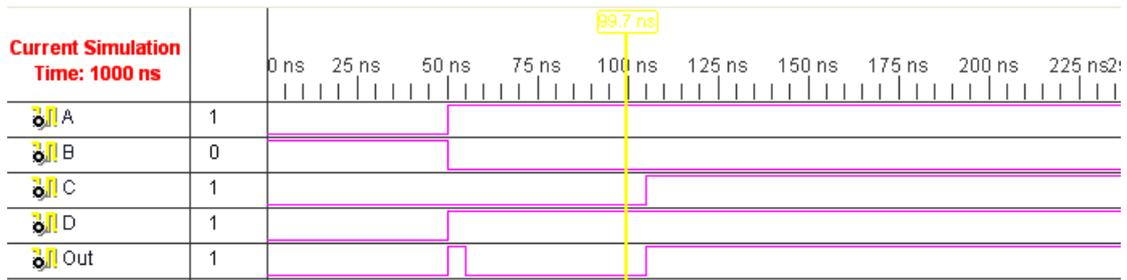
图 8-18 逻辑电路的毛刺示意图
