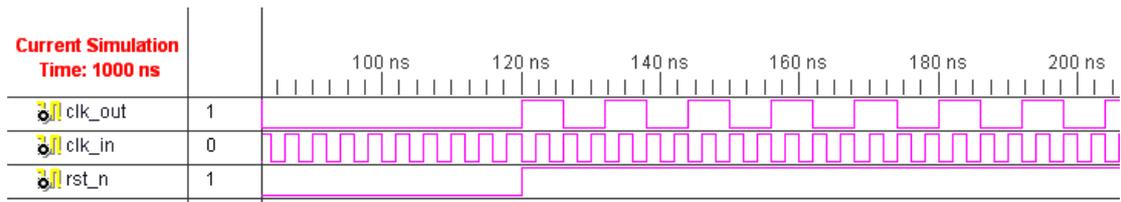
图 11-2 3 分频电路仿真结果示意图
