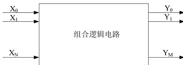
图 8-1 组合逻辑结构示意图
