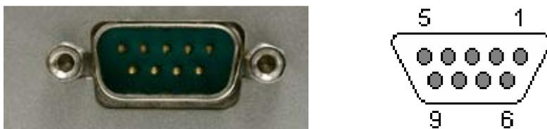
图 13-1 串口的物理形状示意图
